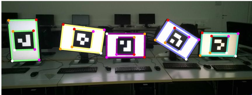
**Abbildung 3.22:** Da die Ausgangsrotation der Markermuster bekannt ist, können den gefundenen Bildschirmeckpunkten ihre realen Eckpunkte aufgrund der im Bild gefundenen Rotation der Markermuster zugewiesen werden. Die realen linken oberen Eckpunkte der Bildschirme sind im Bild rot markiert. Die restlichen Eckpunkte sind im Uhrzeigersinn geordnet.
