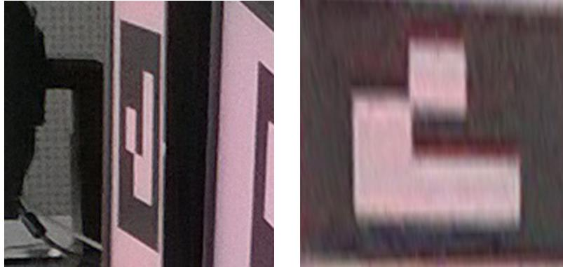
**Abbildung 3.18:** Ein verzerrter Marker im aufgenommenen Bild und nachdem er mithilfe der Homographie-Matrix entzerrt und in ein  $150 \times 150$  Pixel großes Bild gezeichnet wurde.
