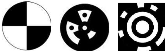
Abbildung 2.4: Beispiele für Kreismarker aus [1].
