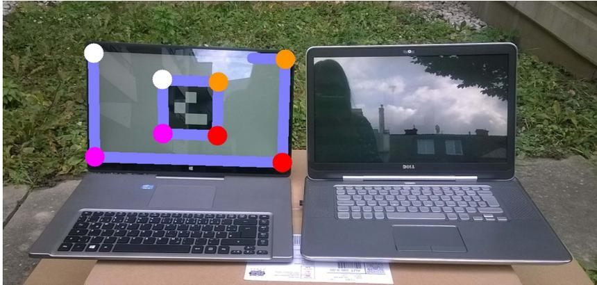
**Abbildung 4.11:** Test der Bildschirmerkennung bei nicht optimalen Lichtbedingungen unter freiem Himmel. Der linke Monitor kann trotz leichter Reflexionen noch erkannt werden. Die obere linke Ecke kann korrekt aus dem Schnittpunkt der linken Kante und dem oberen gefundenen Liniensegment berechnet werden, auch wenn die gesamte Oberkante des Monitors aufgrund der Reflexionen nicht vollständig sichtbar ist. Beim rechten Monitor sind die Reflexionen zu stark, um einen Marker zu erkennen.
