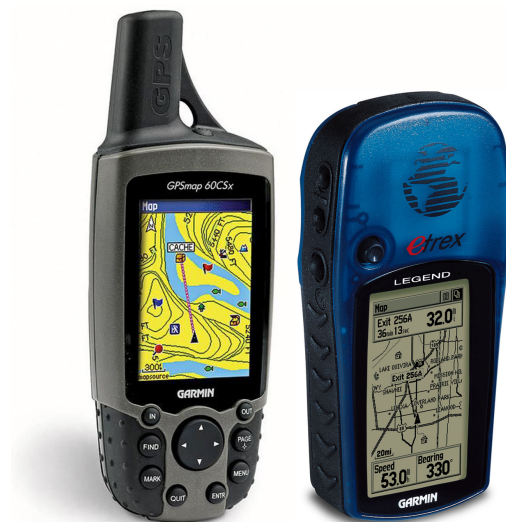
Abbildung 2.3: links: Garmin GPSmap 60CSx mit außen angebrachter Helixantenne. rechts: Deutlich sichtbar die quadratische Patchantenne des Garmin Legend (hinter Logo).
