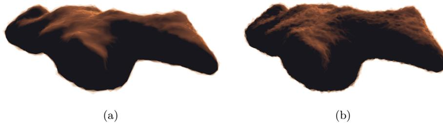
**Abbildung 6.8:** Auswirkungen unterschiedlicher Polygonanzahl auf die Darstellung der Objekte: (a) Modell aus 1000 Polygonen. (b) Modell aus 6000 Polygonen.
