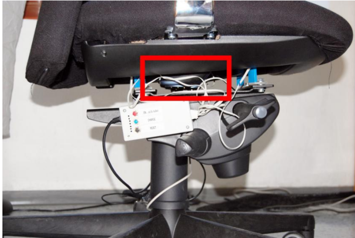
Abbildung 4.2: Der am Bürosessel montierte Gamecontroller (rot eingerahmt).
