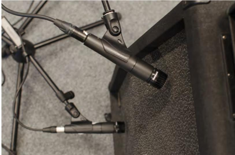
**Abbildung 4.19:** Mikrofonierung eines Gitarrenverstärkers mit zwei Shure SM57 bei den Aufnahmen für *Suitable For Framing*.
