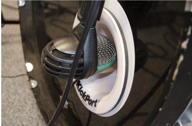
**Abbildung 4.6:** Bei den Kick-Drum-Aufnahmen für *Suitable For Framing* wurde ein AKG D112 in das Resonanzloch hineingerichtet.
