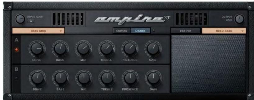
**Abbildung 6.12:** Mit Hilfe von virtuellen Verstärkersimulationen, hier Studio One's *Ampire XT*, kann der Klang von DI-Aufnahmen sehr vielseitig geformt werden.
