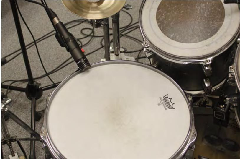
**Abbildung 4.9:** Snare-Mikrofonierung mittels Shure SM57 bei den Aufnahmen für *Suitable For Framing*.
