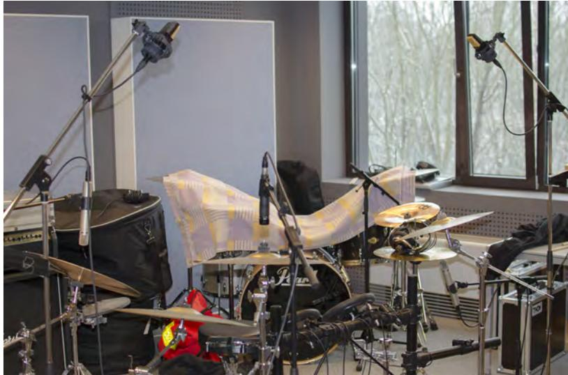
**Abbildung 4.12:** AB-Stereofonie mittels zwei AKG C414 bei den Aufnahmen für Mammon.
