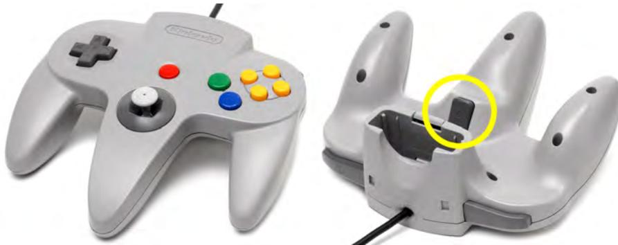
**Abbildung 4.9:** Der Z-Trigger des *N64* Controller. Bilderquelle: [35].
