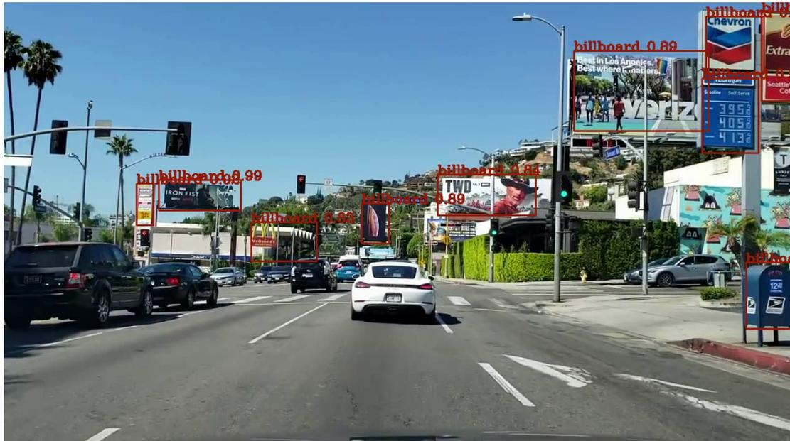
**Abbildung 1.1:** Videoschnappschuss eines Dashcam-Videos [68] mit erkannten Werbungen. Diese werden anhand eines Begrenzungsrahmens sowie der zugehörigen Kategorie und der Zuordnungswahrscheinlichkeit markiert.
