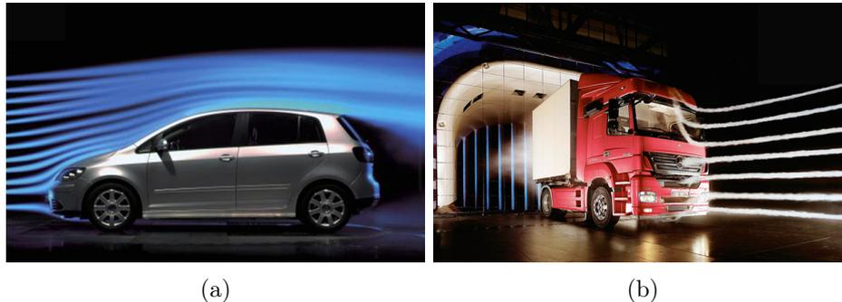
**Abbildung 2.5:** Luftwiderstand bei Autos in einem Windkanal. Auf Grund der Form und Größe ist der Widerstand beim PKW in (a) wesentlich geringer als beim LKW in (b). Quelle (a) [37], (b) [23].
