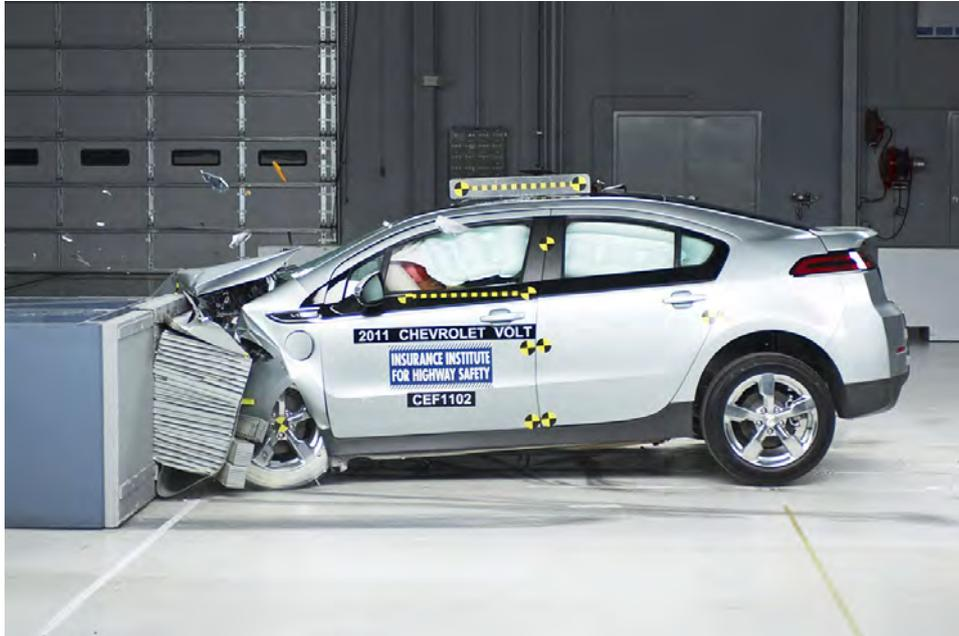
**Abbildung 5.3:** Bild eines Crashtest eines Chevrolet Volt. Durch Slow-Motion wird die genaue Deformation des Fahrzeuges bei einem Zusammenstoß sichtbar. Auf der linken Bildseite sind deutlich fliegende Glassplitter zu erkennen. Bildquelle: [18]
