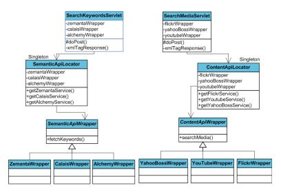
Abbildung 4.4: Klassendiagramm Java-Servlets.
