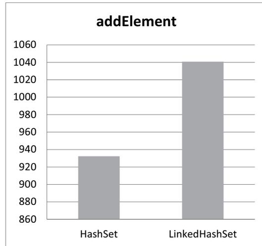
**Abbildung 4.29:** Benötigte Zeit in Millisekunden der getesteten Sets beim Hinzufügen von Elementen bei dem Testgerät Desire HD.
