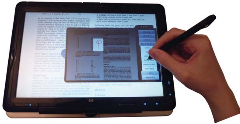
Abbildung 3.7: Videobasierte Hilfestellung mit aufklappbarem Menü zur Auswahl der gesuchten Geste. Darstellung der Geste als Video mit Hervorhebung der Geste durch Abdunkelung unwesentlicher Bereiche.
