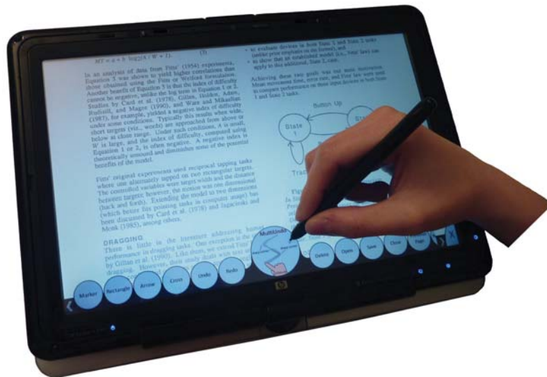
Abbildung 3.2: Statisches Hilfenfenster in Form einer Toolbar am unteren Bildschirmrand mit aufklappbaren Grafiken inklusive Detailtipps zum Erklären der Gestensprache.
