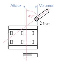
**Abbildung 4.8:** Beispielhafte Positionierung und klangliche Auswirkung der Schräglage bei der Snare-Drum-Mikrofonierung.
