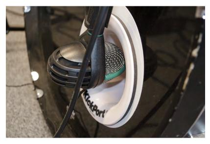
**Abbildung 4.6:** Bei den Kick-Drum-Aufnahmen für Suitable For Framing wurde ein AKG D112 in das Resonanzloch hineingerichtet.
