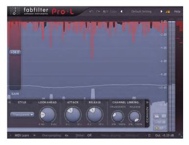
**Abbildung 7.1:** Brick-Wall-Limiter wie FabFilter Pro-L sind unerlässliche Werkzeuge für das zeitgemäße Mastering.
