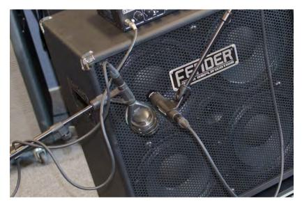
**Abbildung 4.22:** AKG D112 und Shure SM57 zur Mikrofonierung des E-Bassverstärkers bei den Aufnahmen für Mammon.
