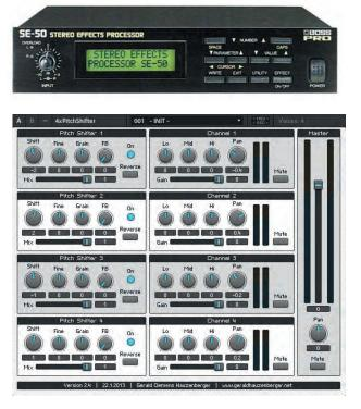
**Abbildung 6.18:** Der im Electro-Industrial häufig für Vocals eingesetzte Pitchshifter-Effekt des Multieffektgeräts Boss SE-50 wurde mittels Native Instruments Reaktor nachgebildet. Bildquelle: [84].
