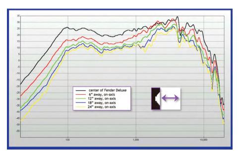
**Abbildung 4.17:** Auswirkungen auf das Frequenzspektrum bei größer werdender Distanz des Mikrofons zum Lautstprecher. Bildquelle: [13, S. 82].
