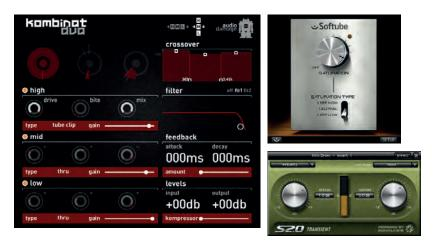
**Abbildung 6.7:** Effekte zur Klangformung von aggressivem Schlagzeug: Multiband-Verzerrung (Audio Damage Kombinat Dva), Röhrensättigung (Softube Saturation Knob) und Transienten-Designer (Sonalksis Transient in Toontrack Superior Drummer).
