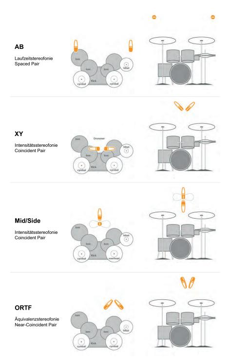
**Abbildung 4.11:** Gängige Verfahren zur Stereo-Mikrofonierung eines Schlagzeugs. Bildquelle: [98].
