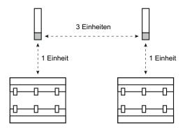
**Abbildung 4.3:** Beispielhafte Darstellung des 3-zu-1-Prinzips bei der Mikrofonplatzierung. Bildquelle: [43, S. 104].
