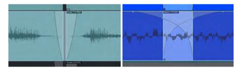
**Abbildung 5.1:** Exponentieller Fade-Out/-In sowie logarithmischer Crossfade von Audioregionen.
