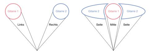
**Abbildung 6.14:** Zwei Konzepte zur Verteilung von E-Gitarren-Aufnahmen im Stereofeld: konventionell hart links und rechts, alternativ mittels Mid/Side-Bearbeitung.
