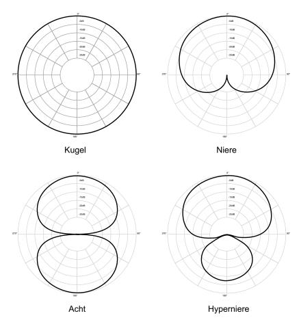
**Abbildung 4.1:** Häufig anzutreffende Richtcharakteristiken bei Studiomikrofonen. Bildquelle: [126].
