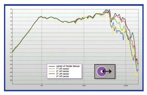
**Abbildung 4.16:** Auswirkungen auf das Frequenzspektrum bei immer weiter vom Lautsprecher-Zentrum entfernten Mikrofonpositionierungen. Bildquelle: [13, S. 81].
