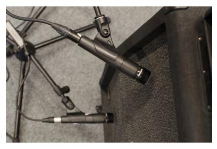
**Abbildung 4.19:** Mikrofonierung eines Gitarrenverstärkers mit zwei Shure SM57 bei den Aufnahmen für Suitable For Framing.
