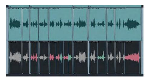
**Abbildung 5.6:** Mittels Elastic Audio korrigierte Vocal-Doppelungsspur beim Mammon-Song *Phosphoros*: grün markierte Regionen wurden gestaucht, rot gekennzeichnete Bereiche verlängert.
