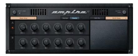
**Abbildung 6.12:** Mit Hilfe von virtuellen Verstärkersimulationen, hier Studio One's  $Ampire\ XT$ , kann der Klang von DI-Aufnahmen sehr vielseitig geformt werden.
