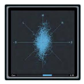
**Abbildung 4.2:** PreSonus Studio One's *Phase Meter* Plug-In zur Anzeige der Stereobreite und Phasenlage eines Stereo-Signals.
