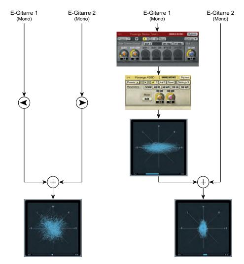
**Abbildung 6.15:** Bei der Doppelung eines Gitarren-Parts liefert eine Mid/Side-Arbeitsweise ein voluminöser klingendes Resultat als das Vorgehen mit hart links/rechts gepanten Gitarren-Aufnahmen und weist eine bessere Mono-Kompatibilität auf.
