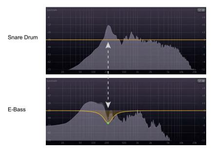
**Abbildung 6.5:** Gespiegelter EQ: im relevanten Frequenzbereich eines Instruments (beispielsweise Snare Drum) werden andere Spuren (hier E-Bass) abgesenkt, um Platz zu schaffen.
