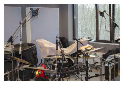
**Abbildung 4.12:** AB-Stereofonie mittels zwei AKG C414 bei den Aufnahmen für Mammon.
