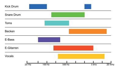
**Abbildung 6.2:** Beispielhafte Verteilung der Klangelemente eines Extreme-Metal-Songs im Frequenzspektrum.
