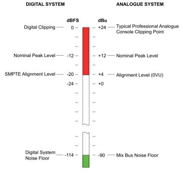
**Abbildung 4.4:** Zusammenhang zwischen dem Dynamikumfang eines digitalen 24-Bit-Aufnahmesystems und dem eines typischen analogen Studiomischpults. Bildquelle: [104].
