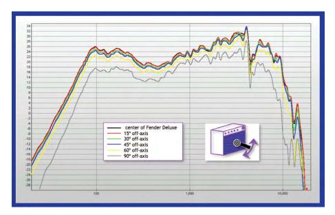
**Abbildung 4.18:** Auswirkungen auf das Frequenzspektrum bei stärker werdender Off-Axis-Ausrichtung des Mikrofons zum Lautsprecher. Bildquelle: [13, S. 83].
