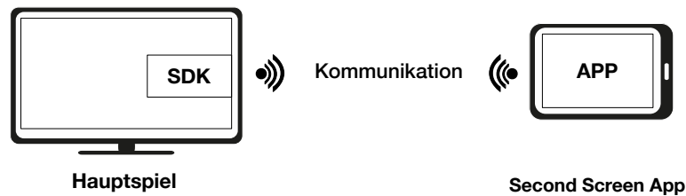
Abbildung 4.6: Entwurf des Frameworks – Das SDK ist in einem Hauptspiel integriert und kommuniziert mit der Second Screen App über eine drahtlose Verbindung. Dabei wird die App auf einem mobilen Endgerät ausgeführt.
