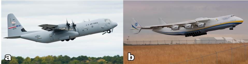
**Abbildung 3.10:** Die *Hercules C-130* (a) [22] und die *Antonov An-225* (b) [16] sind Transportflugzeuge für Kurz- bzw. Langstreckentransporte. Ihre Form unterscheidet sich nicht sonderlich von konventionellen Flugzeugen, wie bei der *Cessna 172* sind die Tragflächen an der Oberkante des Rumpfes angebracht, was sie schwer wirken lässt, da sich dadurch der Schwerpunkt des Flugzeuges nach unten verschiebt.
