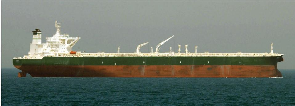
**Abbildung 3.6:** Schiffe, welche für den Transport gebaut wurden zeichnen sich durch ihr schlichtes Design aus, sie sind in die Länge gezogen um viel Fracht aufnehmen zu können aber halten sich in der Breite in Grenzen um den Widerstand und somit den Treibstoffverbrauch zu verringern. Die Brücke befindet sich hinten um den Überblick über das Deck behalten zu können. Bildquelle:[55].
