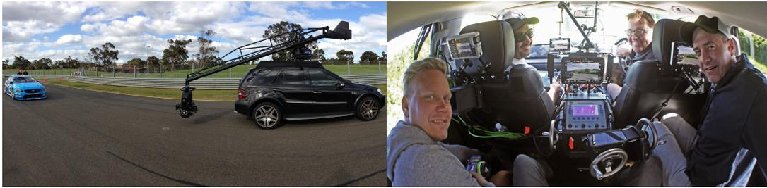
**Abbildung 3.3:** In diesen beiden Abbildungen ist das Scorpio-Arm-Fahrzeug zu sehen. Im linken Bild ist das Auto mit dem Kran abgebildet. In der rechten Abbildung ist das Innere des Autos zu sehen. Von dort aus kann der Kran inklusive Kamerakopf gesteuert werden. Darüber hinaus wird das Bild im Inneren des Autos übertragen. Die gesamte Steuerung der Kamera erfolgt per Funk [48].
