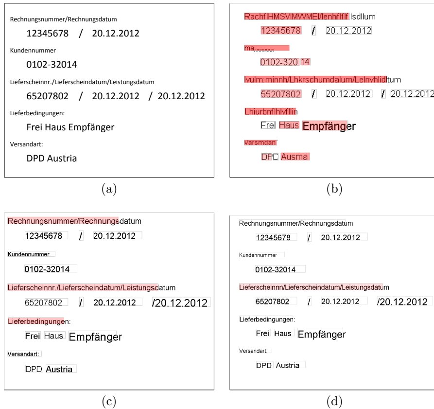
Abbildung 6.1: Ergebnis der Texterkennung bei unterschiedlichen Scanauflösungen. Das Original (a) wurde mit 150 dpi (b), 300 dpi (c) und 600 dpi (d) gescannt.
