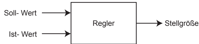
Abbildung 3.4: Grundlegender Aufbau eines Reglers.
