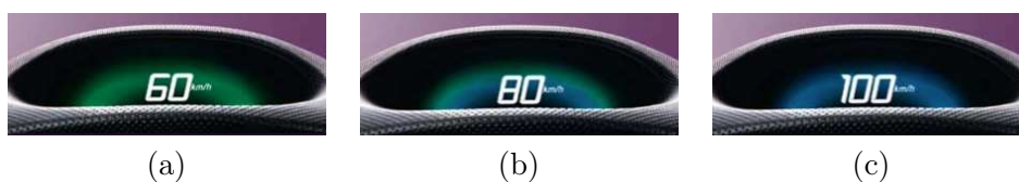
Abbildung 2.1: Ambient Light im Honda Insight Hybrid Car. Der Farbverlauf visualisiert eine: (a) ökonomische, (b) neutrale, (c) unökonomische Fahrweise. (Bildquelle: e-Broschüre Honda Insight 2010)
