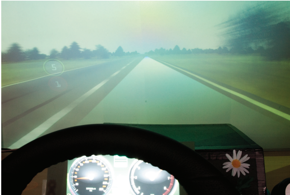
Abbildung 6.14: Ansicht des Cockpits mit der Head-Up-Display Projektion auf die Holo-Projektionsscheibe und der dahinter liegenden Fahrsimulation auf der Hauptprojektionsfläche.
