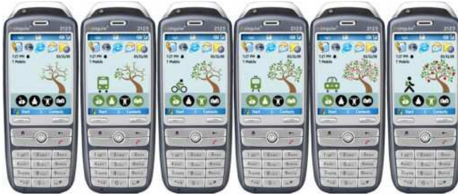
Abbildung 2.7: UbiGreen - Mobiles EcoFeedback für verschiedene Fortbewegungsarten. Der florierende Baum visualisiert den Fortschritt des Anwenders, dessen momentanes Fortbewegungsmittel als Symbol dargestellt wird. Vier runde Symbole im unteren Bereich des Displays geben Auskunft über die Vorteile, die der Anwender aus dem momentanen Handeln zieht, wie z. B. Geldersparnis, Entspannung, Training und die Möglichkeit zu lesen.
